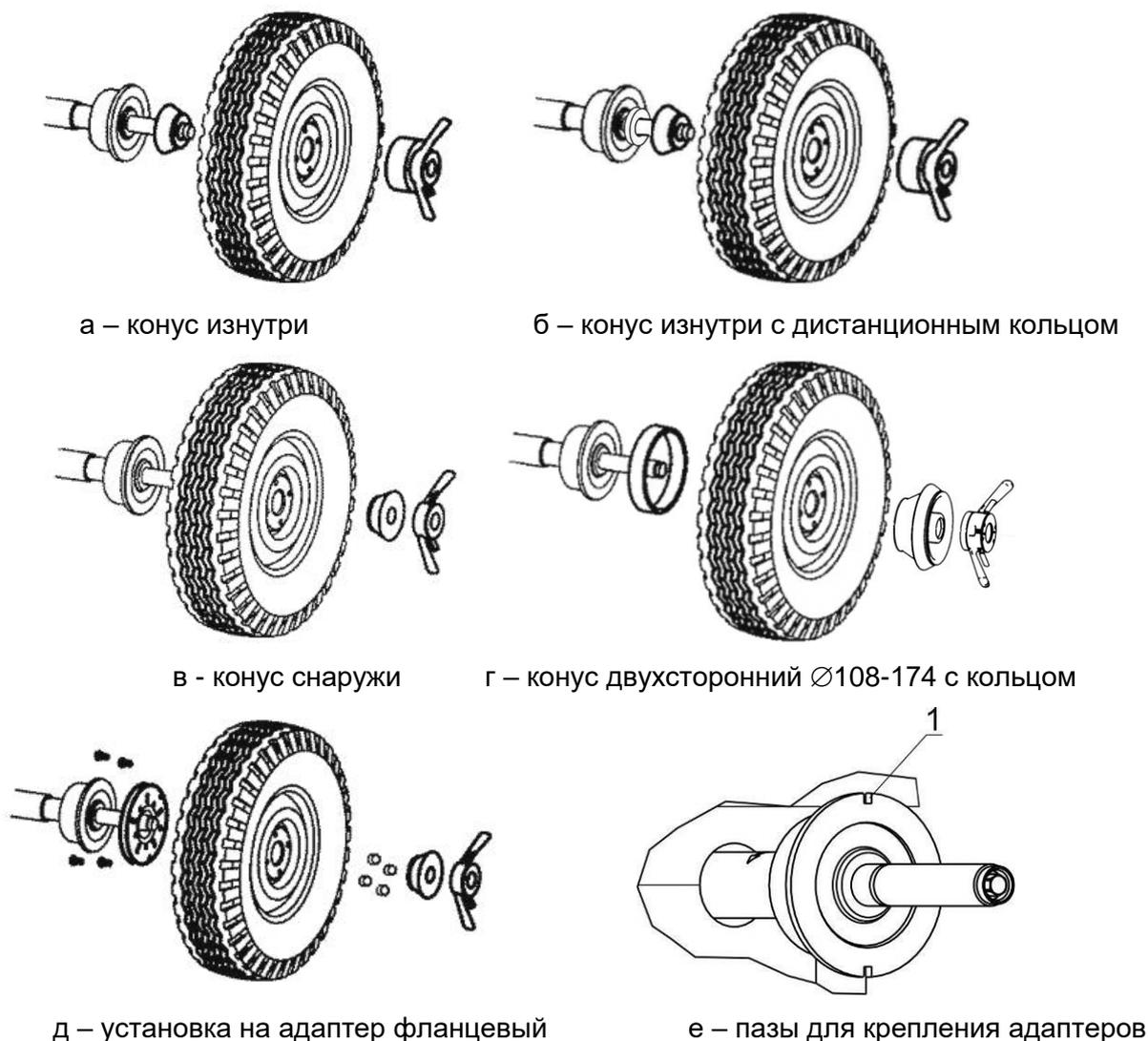
Рисунок 5.1 – Установка колеса
