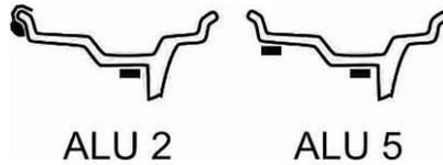
Рисунок 7.3 – Допустимые схемы установки грузов для режима Split
