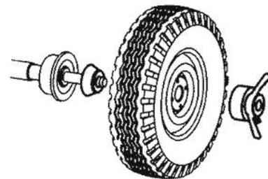
Рисунок 6.5 – Установка колеса
