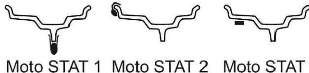
г – статическая балансировка мотоциклетных колес
