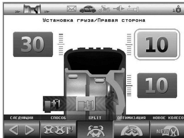
Рисунок 7.5 – Экран установки грузов в режиме Split
