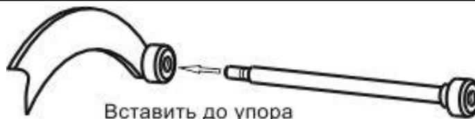
Рисунок 7.6 – Использование удлинителя линейки
