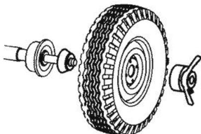
Рисунок 6.1 – Установка колеса
