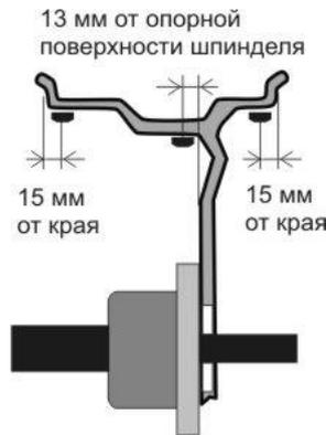
Рисунок 5.16 – Дистанции установки ленточных грузов вручную
