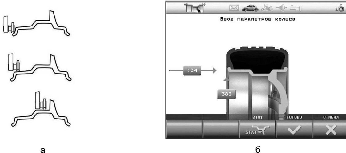
Рисунок 5.9 – Измерение для схем STAT и Moto Stat
